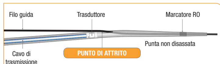
Struttura della punta del catetere IVUS standard
