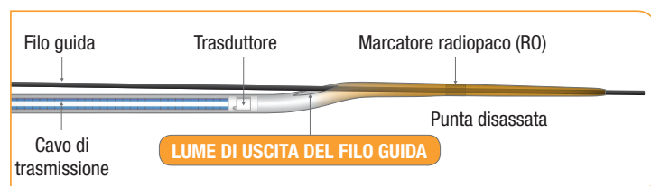
Struttura della punta disassata Kodama
